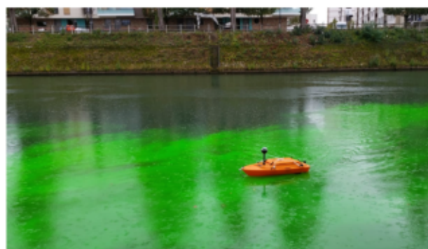
Figure 14: Gauche : l'opération de prélèvement manuel à la canne, effectuée à l'arrière du bateau Mindanao (future site d'installation des capteurs in-situ « aval »). Le DRONE est en position de prélèvement à 10m. Droite : le DRONE en position de prélèvement à 5m.
