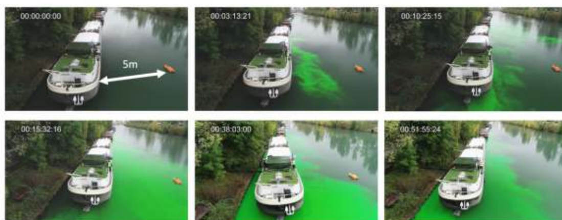
Figure 18: Suite temporelle d'images aériennes, permettant de visualiser la dispersion du traceur (fluorescéine) depuis le largage des toilettes ( t=3 min), au moment de l'étendue latérale maximale de la pollution ( t=15 min), et ensuite jusqu'à la fin de l'étude
