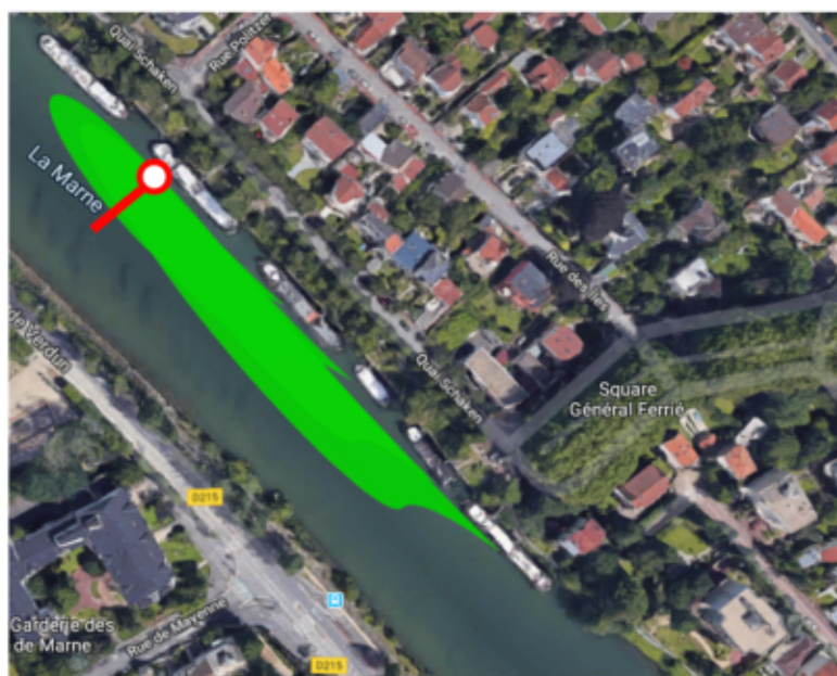
Figure 13: Schéma de l'étude de dispersion : la tâche verte indique la zone affectée par le largage de la fluorescéine présente dans les eaux usées rejetées, le cercle rouge représente le point de prélèvement manuel, et la ligne rouge représente le périmètre couvert par les prélèvements du DRONE
