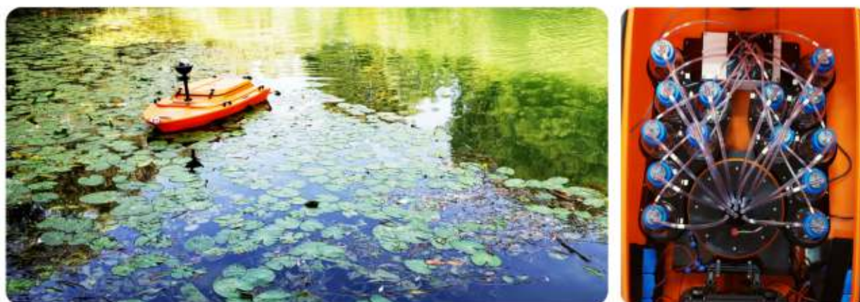
Figure 8: Le FLUIDION DRONE (gauche) équipé de système de prélèvement RS-14V certifié ETV (droite)
